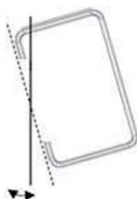
Rys. 5. Skrzywienie słupa przy wbijaniu
