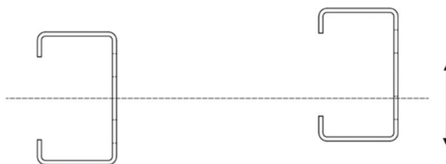
Rys. 6. Odsunięcie od osi osadzenia słupów
